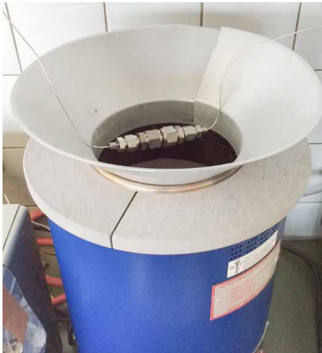
Miniboiler van de Universiteit Gent, die de stoom- en watercyclus van een bedrijf simuleert om vooraf de kwaliteit van gezuiverd water te testen. (Foto: UGent, Evelyn De Meyer)
